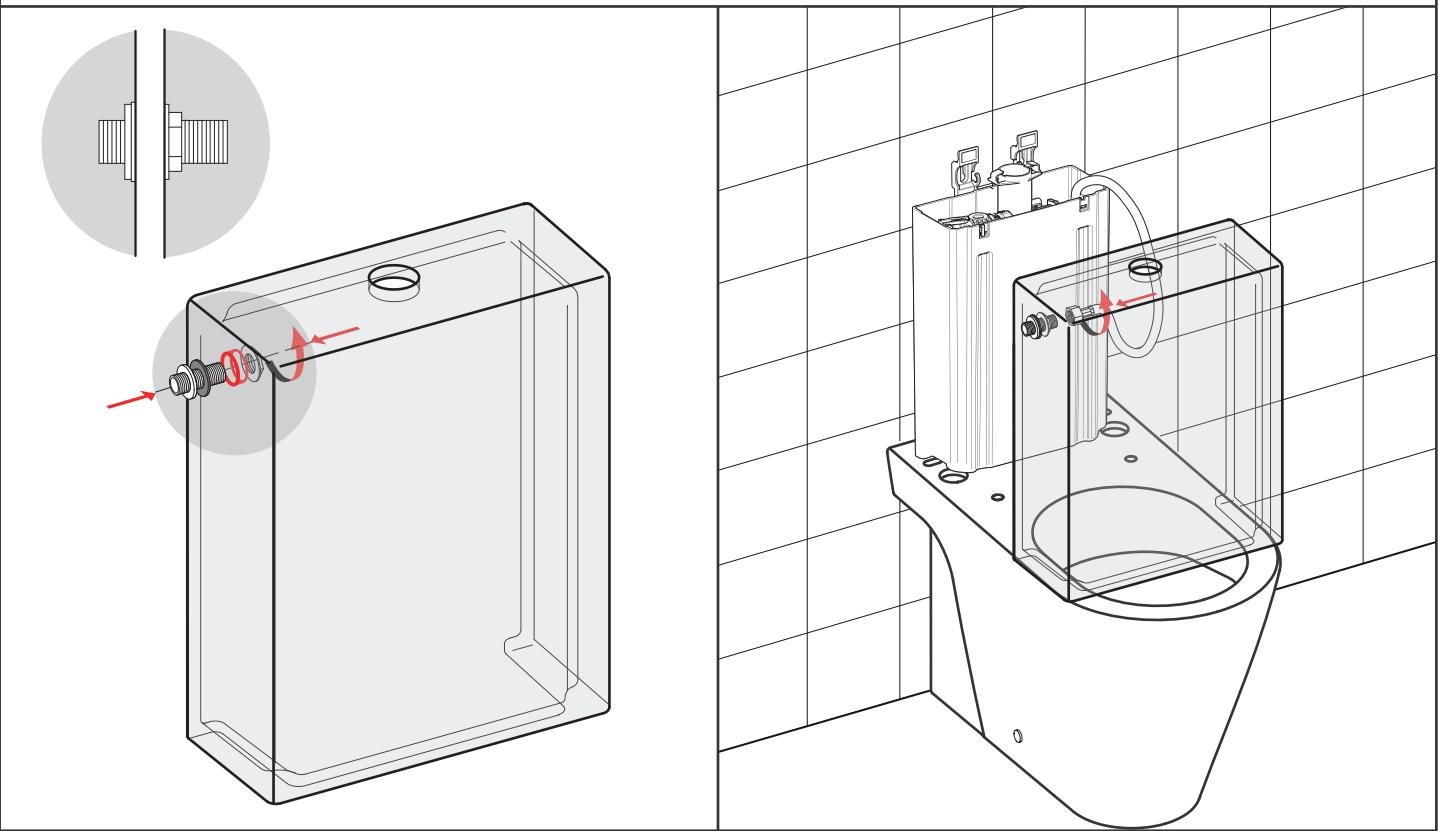
Aprire il foro predisposto per l'alimentazione laterale alta e posizionare il raccordo idraulico
