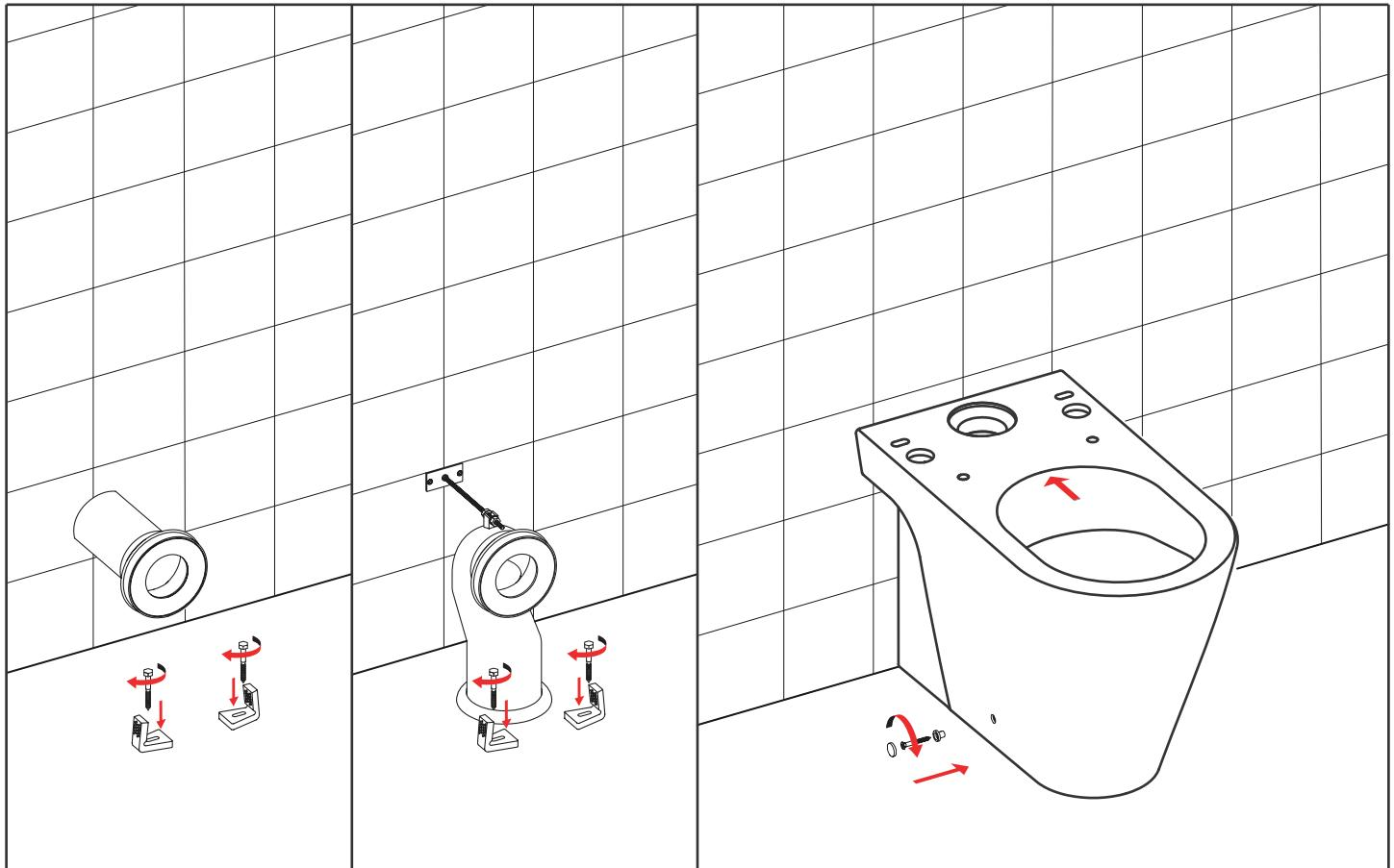
Predisporre i raccordi per lo scarico a parete o a terra e ancorare i fissaggi a pavimento
